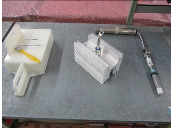
Figura 22 – Componente montado no Dissipador
