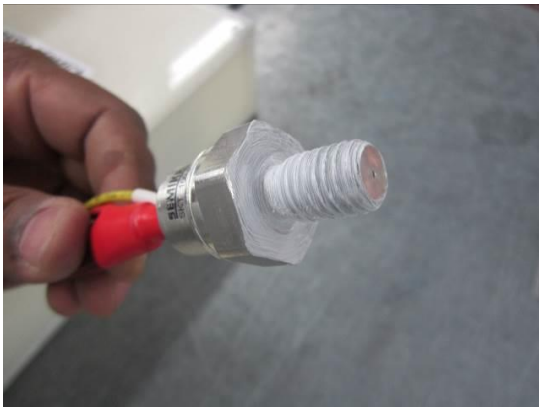
Figura 26 - Aspecto após aplicação da pasta
