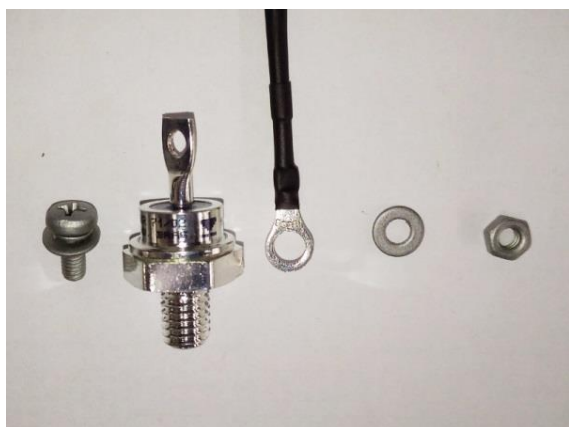
Figura 8 - Itens necessários para conexão via parafuso e porca
