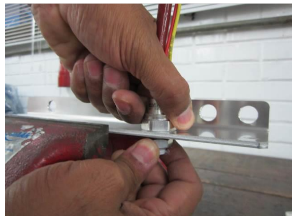
Figura 29 - Inserção completa do Tiristor
