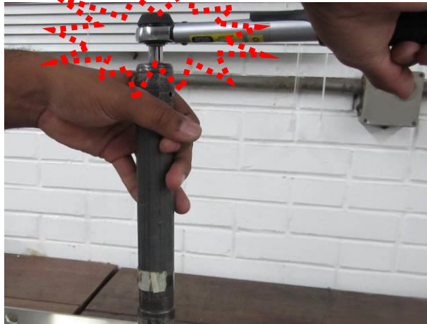
Figura 32 - Torque deve ser finalizado ao primeiro estalo sonoro (torquímetro tipo catraca)
