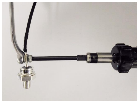
Figura 9 - Finalizando a conexão elétrica com o torquímetro e chave de boca
