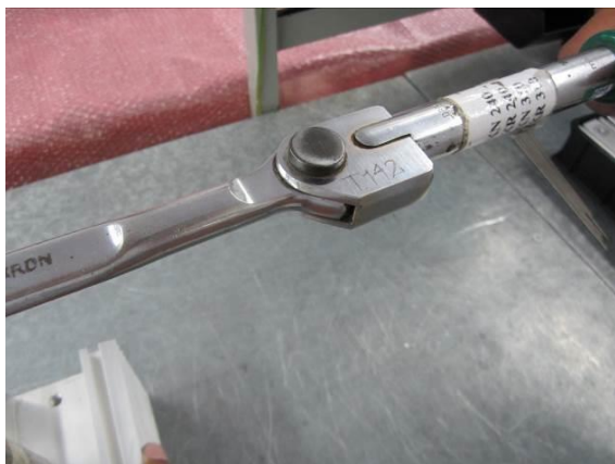
Figura 20 - Cabo do torquímetro antes de chegar no torque especificado
