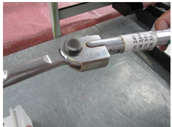
Figura 21 - Cabo do torquímetro após chegar no torque especificado
